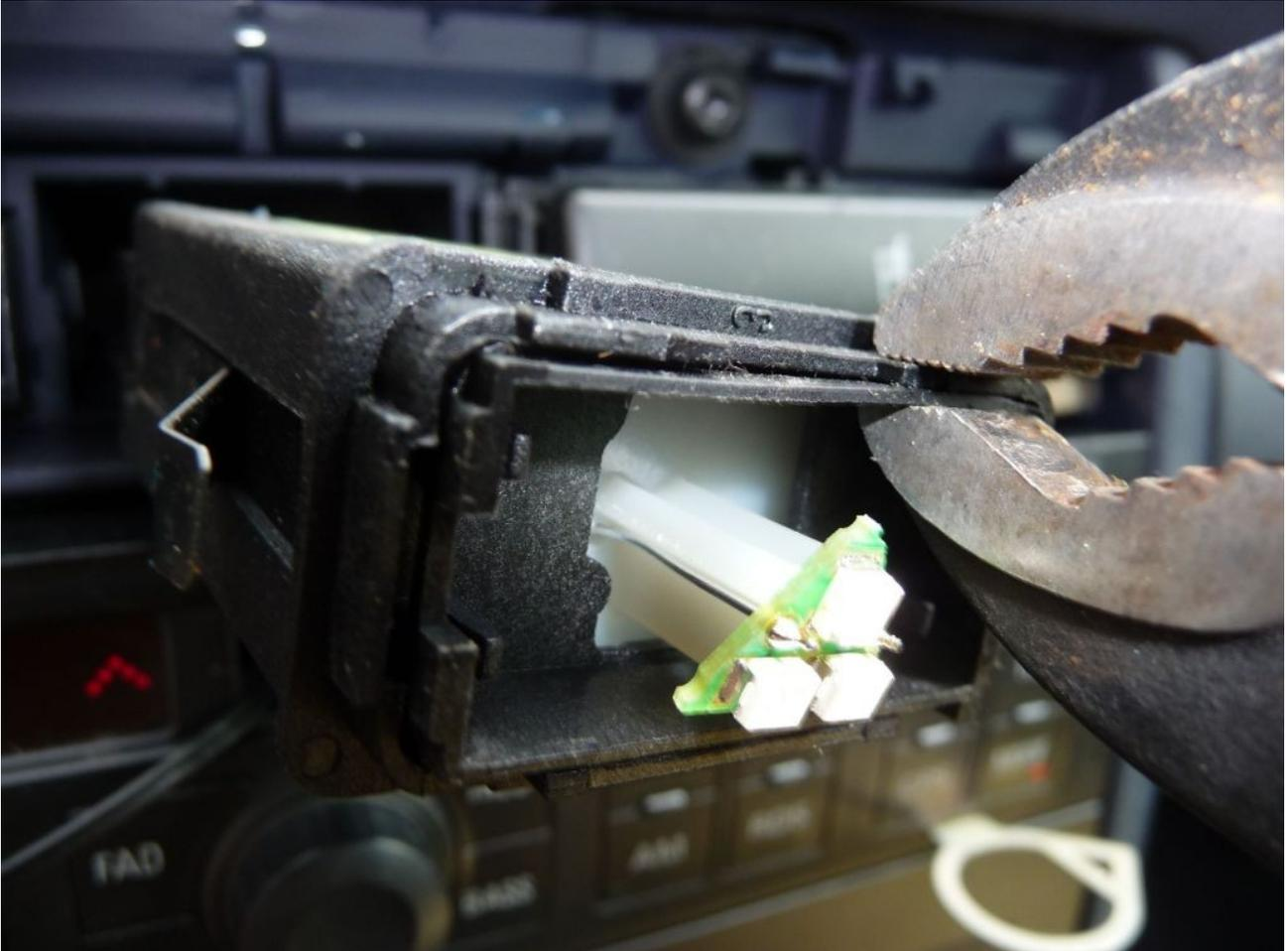
Steckerseitig öffnet man das Modul mit einem Schraubendreher.
